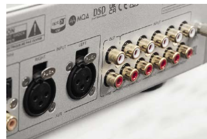
W strefie analogowej mamy przedwzmacniacz gramofonowy dla wkładek MM oraz liniowe wejście zbalansowane.
